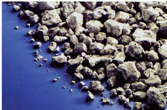
種用途に利用されている。転炉鋼1tあたり約130kg生成する。近年では転炉精錬の前工程でリン(P)や硫黄(S)を除去する溶銑予備処理が普及し、ここで生成するスラグも転炉系スラグに分類される。
