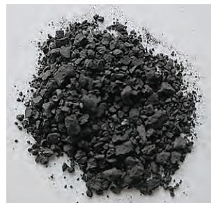
電気炉酸化スラグ細骨材
