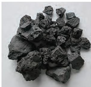
電気炉酸化スラグ粗骨材
