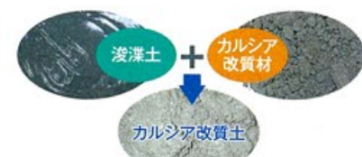
製鋼スラグを成分管理・粒度調整したカルシア改質材と浚渫土を混ぜると、水和反応で結合し固化する
