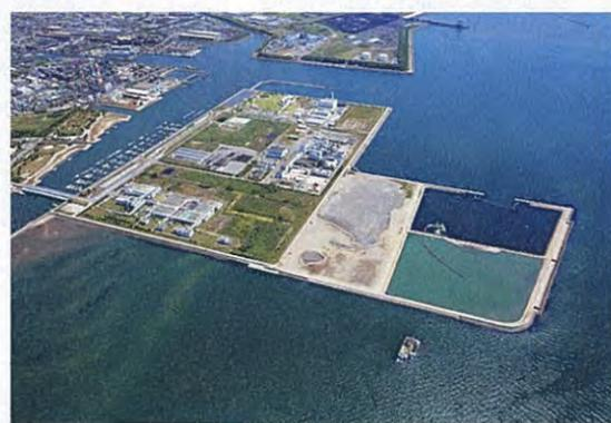
L字型の部分は網干浜埋立地。網干沖カルシア藻場造成工事は、この埋立地の手前、右端の部分で行われた。藻場造成の範囲は3期にわたる工事全体で、幅357m×奥行き70mに及ぶ。浚渫土や改良土はこれら造成工とは別に、写真上方の広畑航路や夢前岸壁で行われた
