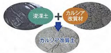
製鋼スラグを成分管理・粒度調整したカルシア改質材と浚渫土を混ぜると、水和反応で結合し固化する
