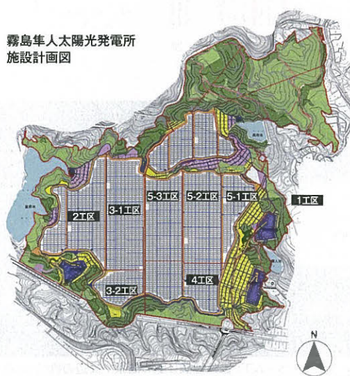
この太陽光発電所造成工事は、開発区域約43ha、造成土量約100万㎡に及ぶ大規模なもの。3つの調整池を整備したうえで、区域全体を8つの工区に分け、工区ごとに「カタマ®SP」を用いた簡易舗装工事を施した
