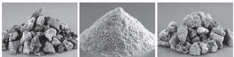
左から、製鋼スラグ、高炉水砕スラグ、高炉徐冷スラグ。 さまざまな用途に応じて製造・加工を行っている。
