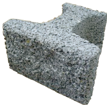
消波ブロック（福井港） 〔細骨材にEFSを100% 使用〕
